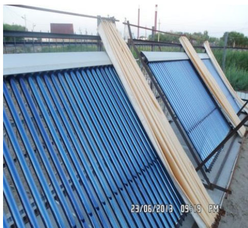
Рисунок 2 - Экспериментальная гелиоустановка для тепловой обработки различных бетонов
